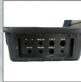
Утопленная панель разъемов с крышкой
