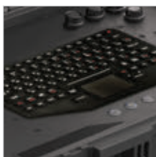
Клавиатура силиконовая с тачпадом и регулируемой подсветкой
